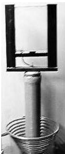
Рис. 86. Прозрачный токопроводящий электрод, закрепленный на выходном зажиме высокочастотного малогабаритного трансформатора Тесла
